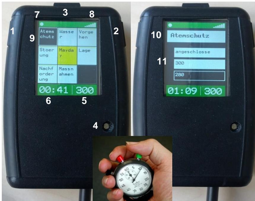
Bild 1: Handgerät des EmergencyMessengers. (links) Anzeige der 8 Kategorien von Routinemeldungen. (rechts) Auswahl einer Kategorie (hier: Atemschutz) mit zugeordneten Meldungen. Zum Vergleich eine Stoppuhr als Modell des Interaktionsschemas zur einhändigen Bedienung (unten).
